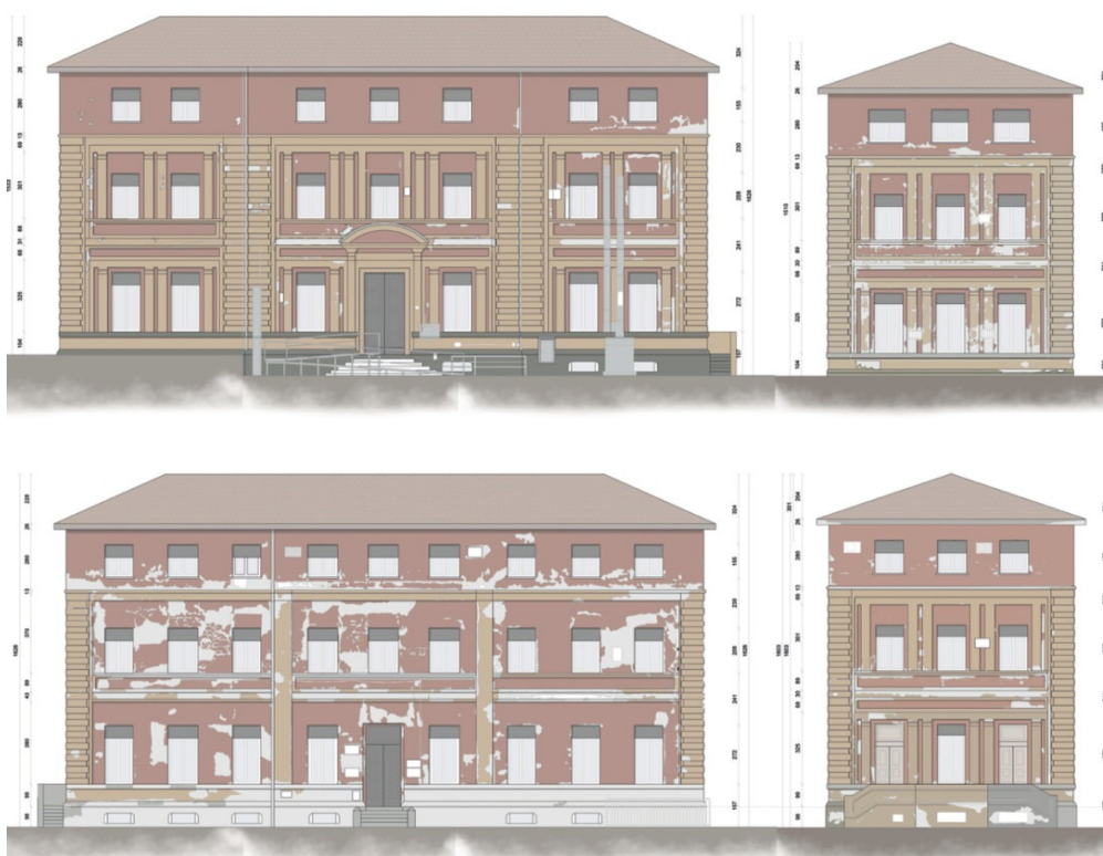
Fig. 9 Prospetti e rilievo del degrado materico
